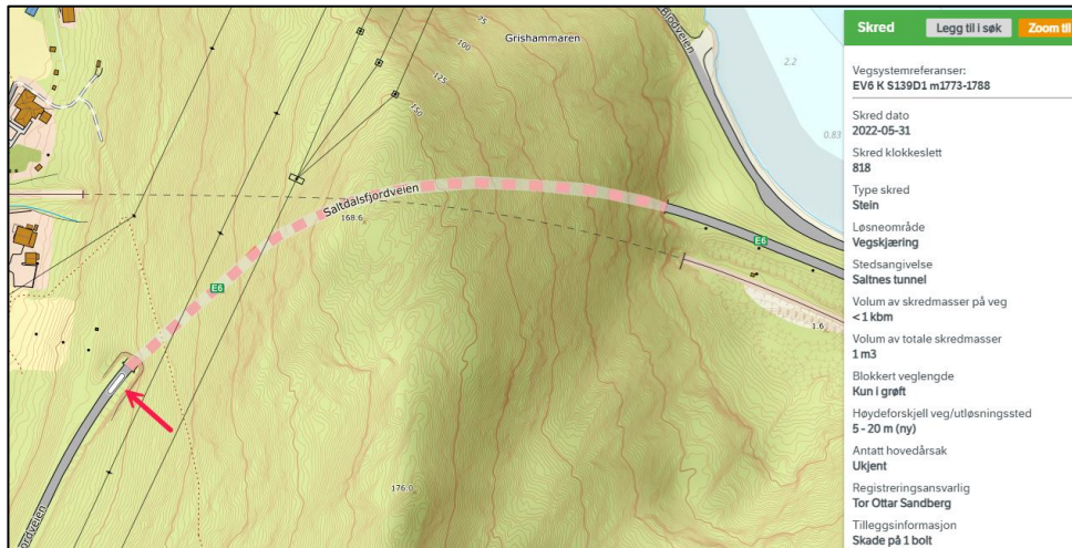
Figur 2. Registrerte nedfall i forbindelse med Saltnesttunnelen.
